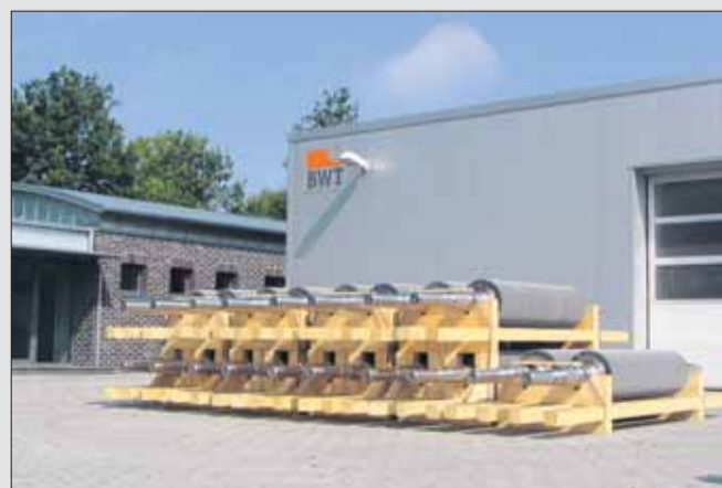
Großauftrag für ThyssenKrup Nirosta: 18 Bürstenwalzen für die neue Beize in Düsseldorf-Benrath. Bürstenkörper komplett aus säurebeständigem Edelstahl 1.4571 (V4A).
